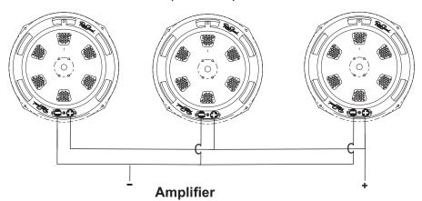
2 Ohm Subwoofer: .67 Ohm 4 Ohm Subwoofer: 1.33 Ohms
